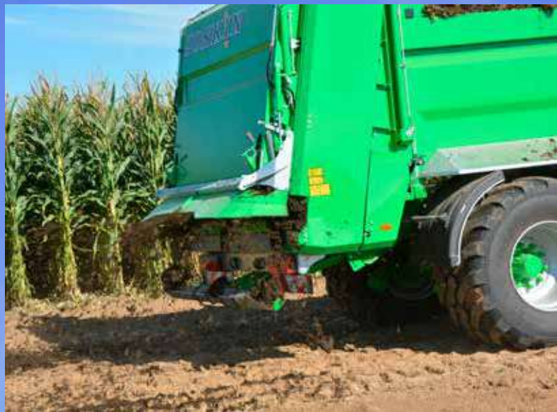
Jednoosiowy rozrzutnik obornika Ferti-Space2 FS5511/15U charakteryzuje się skrzynią o długości 5,5 m, szerokości 2,1-2,13 m i wysokości 1,05 m.
