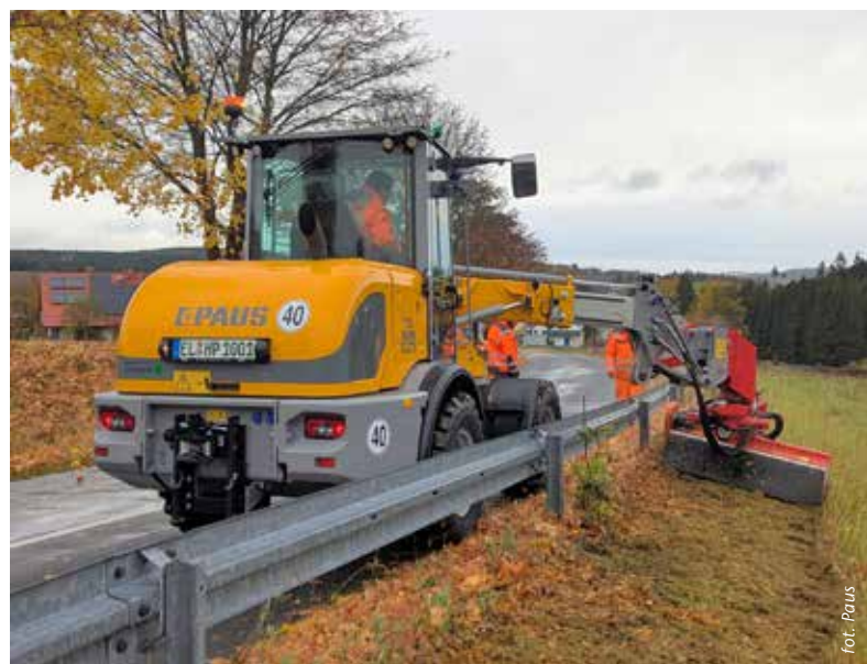
Ładowarka TSL 9088 Pro z teleskopowym ramieniem obrotowym umożliwia podawanie materiału z boku i pracę na wysokości do 4 m.
