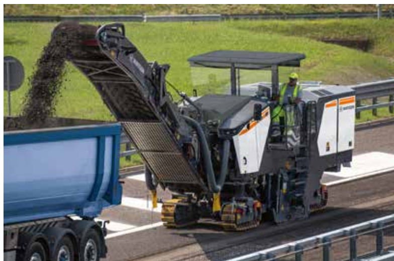
Model W 250 XF wyposażono w dwa silniki John Deere o łącznej mocy 900 kW (1207 KM), a system Mill Assist umożliwia dostosowanie parametrów pracy.
