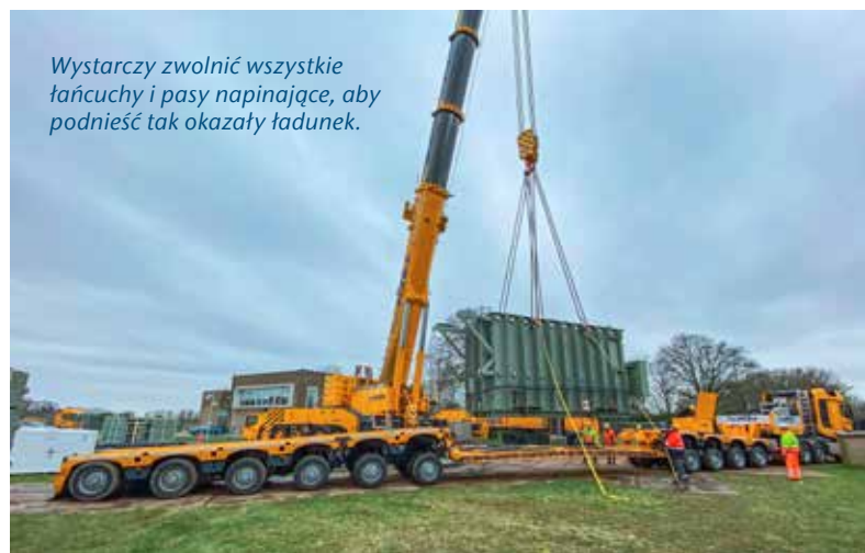
88-tonowy transformator został przetransportowany niskopodwoziówką CombiMAX firmy Faymonville.
