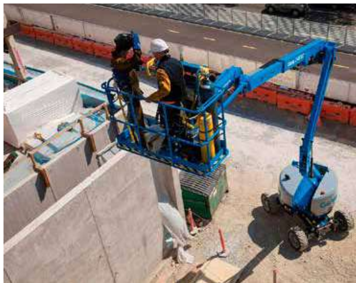
Podnośnik przegubowy Z-45 XC zapewnia wysokość roboczą 15,86 m oraz wysięg boczny 7,55 m.
