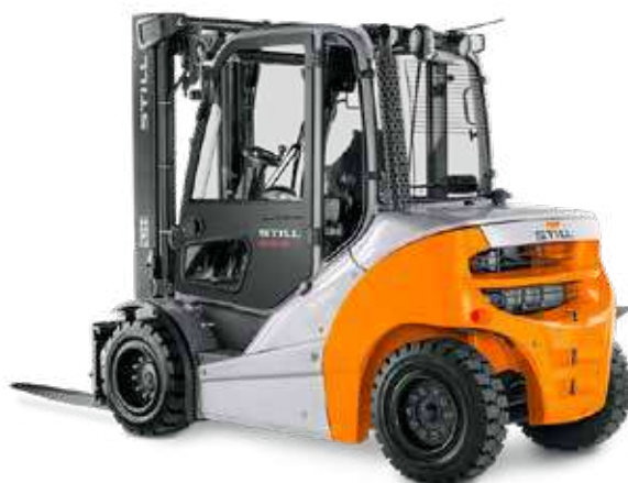
RX 70 wyposażony został w napęd spalinowo-elektryczny. Rozwiązanie to łączy zalety dużej mocy silnika spalinowego z wysoką precyzją działania silnika elektrycznego.
