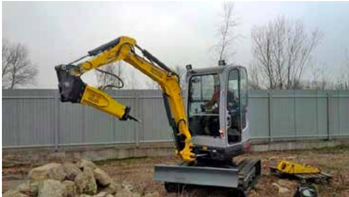
Firma Keltec wykonuje płyty adaptacyjne do młotów hydraulicznych, standardowe i pod szybkozłączca.
