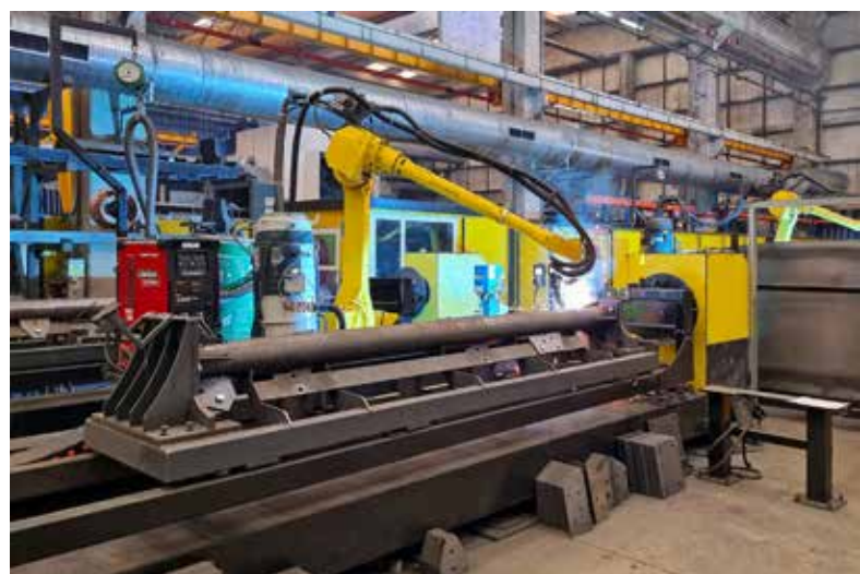
Zrobotyzowana linia produkcyjna podpór silosów na cement.
