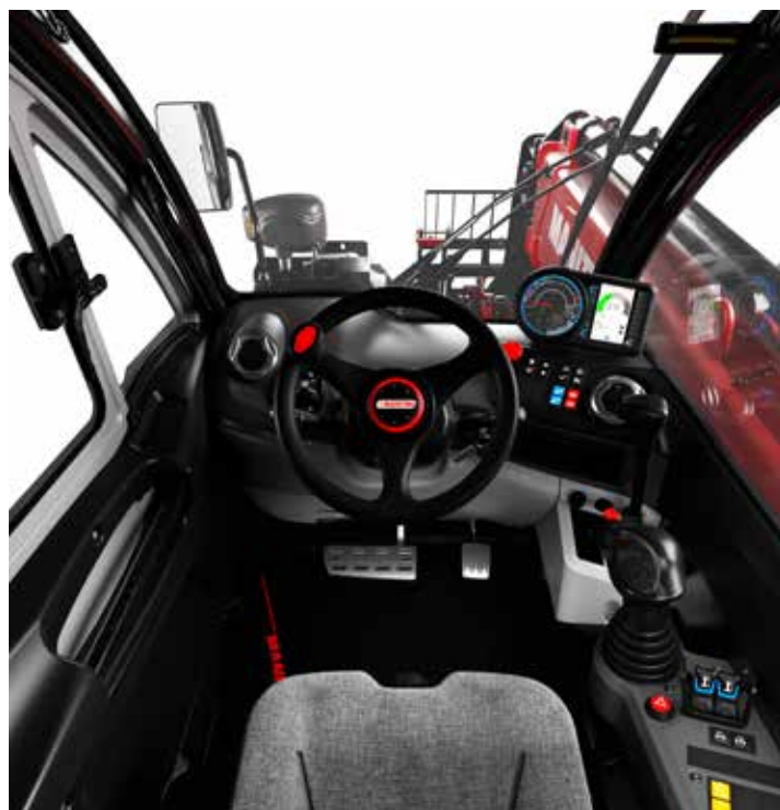
Nowe wnętrze kabiny obejmuje: wejście „Easy-Step”, poprawiające komfort i bezpieczeństwo wchodzenia i wychodzenia z kabiny, standardowe osłony przeciwsłoneczne czy wyświetlacz „Harmony”.
